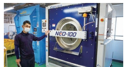
▲クリーニング工場で使用している全自動水洗脱水機
