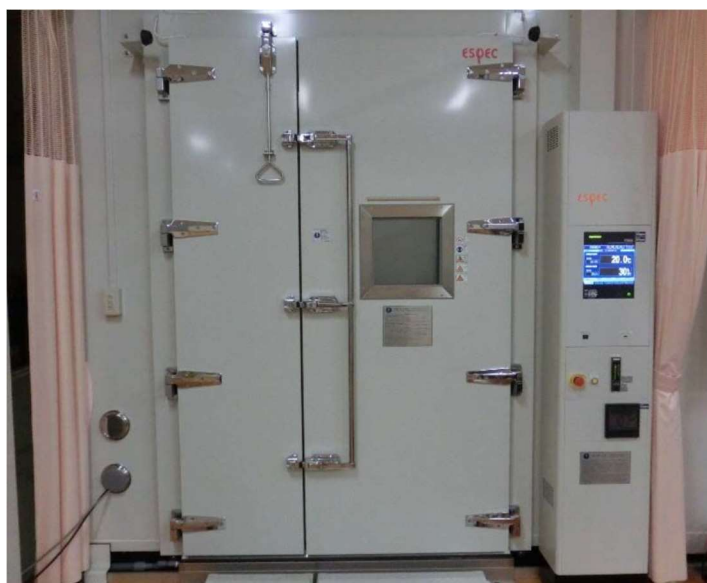
〈図2〉人工気象室（左：外観、右：運転中画面）
