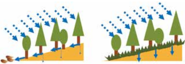
図7 下層植生衰退地における土壌流出のメカニズム（左：下層植生衰退地、右：通常の森林） 下層植生がなく地面がむき出しになっていると、降った雨が地中にしみ込みにくくなり、降雨の際に短時間に地表を流れ去る地表流の割合が増えます。地表を流れる水に土壌も流され、森林土壌は貧弱になります。流された土壌は下流で濁水となります。
