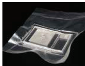
図1: 「ポンプレスドロップレット生成チップ」 図2: 生成したドロップレット
