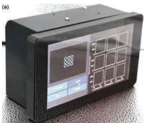
図：(a) 細胞センサチップの応答シグナルを検出可能な小型蛍光イメージャ (b) 原始的な膜構成要素と考えられるモノグリセリドと脂肪酸からなる膜のイオン透過機構の模式図
