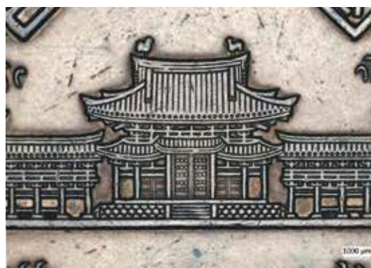
図4：タイル合成機能を使い撮影した10円玉 (大きさ：24191×18162ピクセル) 〔高倍率レンズ撮影画像100枚をタイル合成〕
