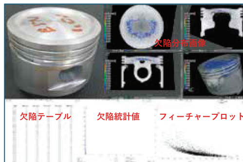
図3：アルミダイカスト部品の解析結果
