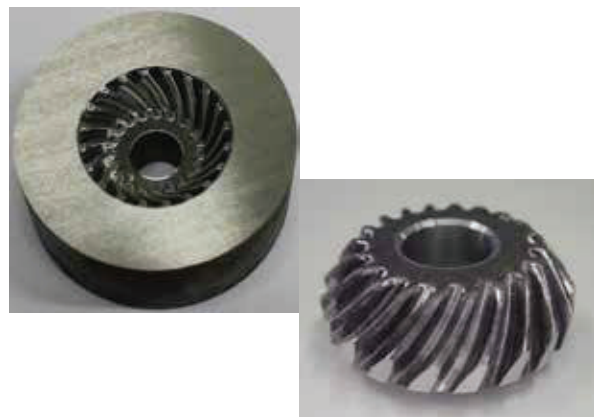
図2：ギヤ金型(5軸制御マシニングセンタで加工)と鍛造ギヤ(ギヤ金型で鍛造加工)
