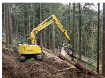
高性能林業機械（ハーベスタ）を利用した伐木作業の様子
