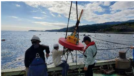
通信機能を備えた機器を設置したブイ
