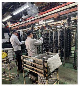
作業風景:粗材をハンガーと呼ばれる治具 に取付け、めっき自動搬送ラインへ投入
