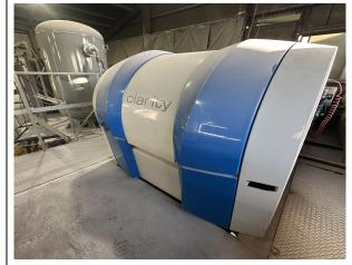
設備写真:ガラス以外の不純物を除去する 光学式選別機
