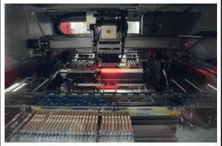
設備写真: 先端設備マウンターによる実装
