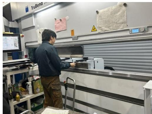
※バンダー：ステンレスや鋼板など金型により曲げ加工を行う機械。
