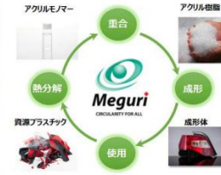
アクリル樹脂のケミカルリサイクルの仕組み
