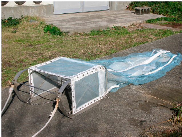
図2 小型甲殻類の採集に用いたソリネット Fig. 2 Dredge used for collecting benthic animals in the beach.
