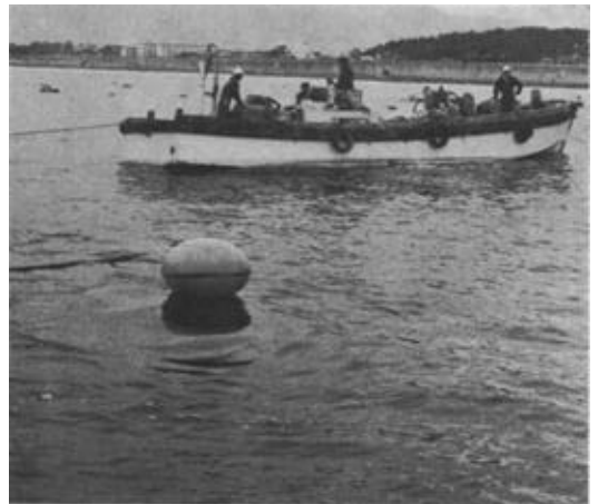
写真5 一方固定具が取り付け器に固定されずにバックのみが浮上（夏網第3次試験）
