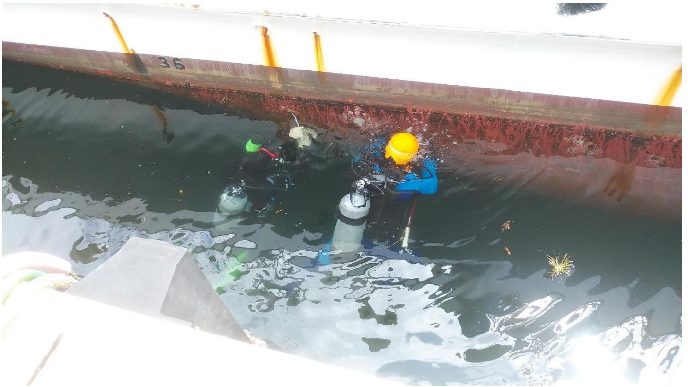
潜水による実際の船底点検の様子
