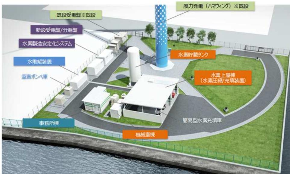
**燃料電池フォークリフト12台、簡易型水素充填車2台**を用いた水素供給を検証
