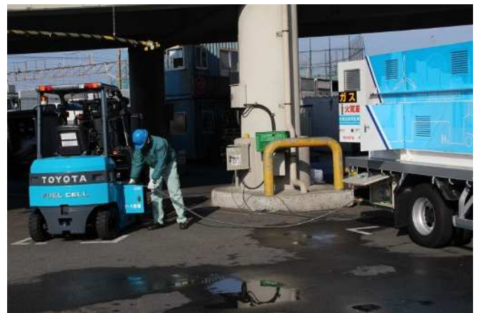
水素充填作業 (横浜市中心卸売市場本場青果部)
