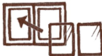
今ある窓の障子部分からガラスのみを取り外し、Low-E複層ガラスなどの断熱性能が高いガラスに交換する方法
