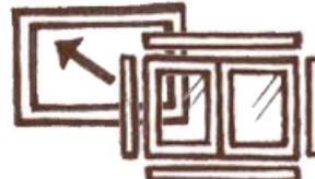
今ある窓サッシ枠に新しい枠をかぶせる方法
