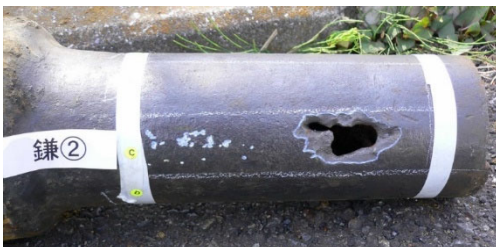
(水道管(1935年布設)の腐食状況)
