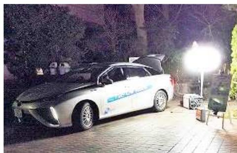
FCVで発電した電気を照明へ給電
