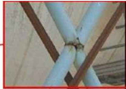
東日本大震災で、他県で破断した高圧ガスの脚柱
