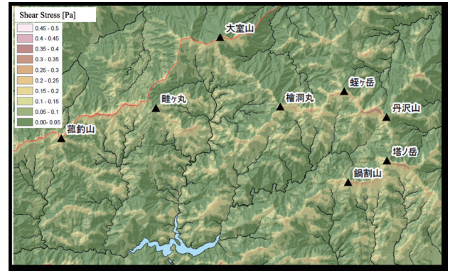
図4 地表面せん断応力分布 - 南風
