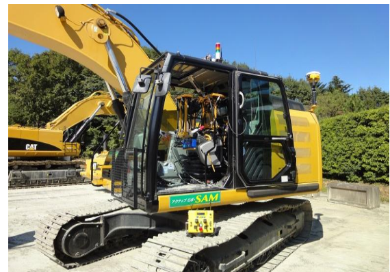
図2 無線遠隔操縦ロボットを搭載した重機
