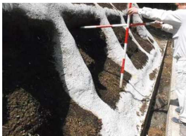
緑化試験施工箇所のモニタリング調査の様子
