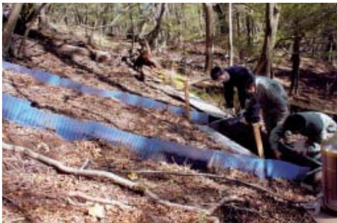
東丹沢の堂平地区では、シカの採食により、森林の中に草やササ（林床植生）の生えていない地域が広がっています。ここに試験斜面をつくり、降雨が土壌を削った量（土壌浸食量）を1～2週間毎に、また地表面を流れた水の量（地表面流出量）を1～2分毎に測り、採食との関係を調べています。林床植生がほとんどない斜面では、今年7月からの約3ヶ月間で、平均して深さ約4mmの土壌が浸食されたことがわかり、影響の大きさが確かめられました。写真は幅2m、長さ5mの試験斜面。下部の水槽に溜まった土砂や水、落ち葉の量を測定します。
