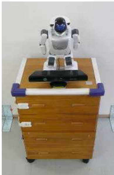
図1 可動式キャビネットを用いた全体システム キャビネット内には、計測データを保存し、時系列分析するためのPC、電力供給のためのバッテリー等を内蔵
