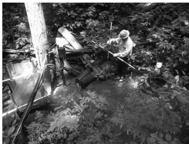
写真8 貝沢No.1 水文観測地点の量水堰の土砂堆積状況 (平成23年8月5日撮影)
