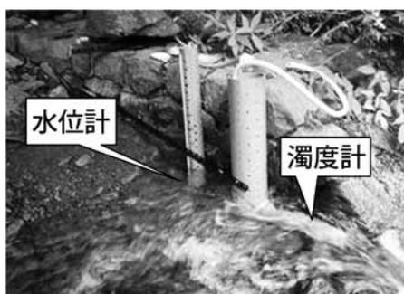
写真1 ワサビ沢に設置した水位計、濁度計
