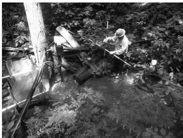
写真8 貝沢No.1水文観測地点の量水堰の土砂堆積状況
