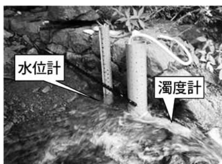
写真1 ワサビ沢に設置した水位計、濁度計
