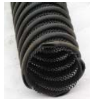
写真 使用した暗渠管
