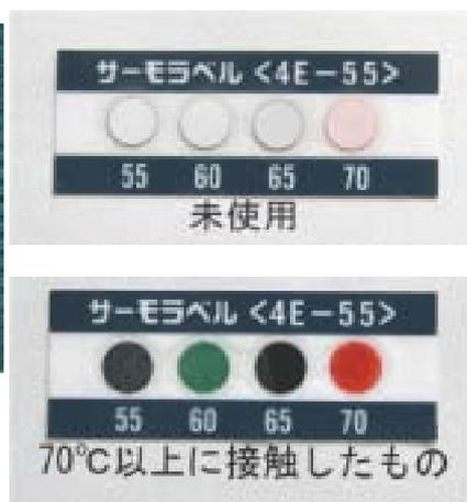
図2 サーモラベルの温度表示
