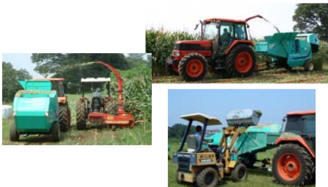
図 1 細断型ロールベアラの作業方式
