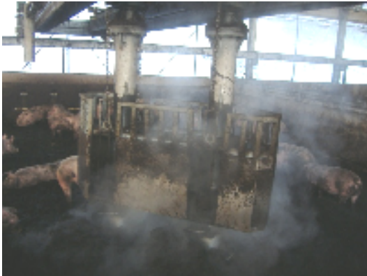
図1 スクリュー型敷料攪拌装置による攪拌の様子
