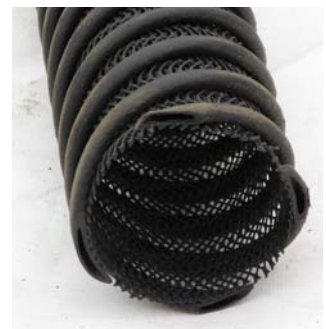
写真1 供試した全面有孔の暗渠管
