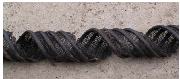
写真 2 網目が裂け伸びた暗渠管
