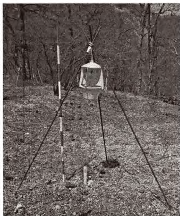
写真1 黄色の衝突板トラップの設置状況
