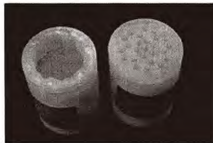
図2 フラックス捕捉型パッシブサンプラー（左）と拡散型パッシブサンプラー（右）
