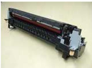
複写機等における消費電力の約7割を占める定着器（トナーインクを熱で溶かし、用紙に定着させる装置）の電力消費を削減するため、これまで電磁誘導加熱が困難であると言われていた銅を薄膜化し、定着ベルトに利用するIH定着技術を開発した。この技術を用いることにより、複写機等で従来必要とされた待機時や節電モード時の予熱を不要とするとともに、従来機種で20秒程度であった定着器の立ち上げ時間を3秒以内に短縮し、利便性の向上はもとより、運用時の消費電力とCO<sub>2</sub>の大幅な削減を図ることが可能な製品を開発した。
