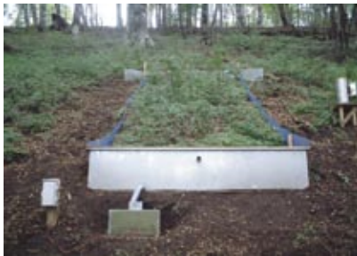
土壌侵食量調査の試験区画（堂平）。左：被度大（植生保護柵内、植被率80%）中：被度中（植生保護柵内、植被率40%）右：被度小（植生保護柵、植被率約1%）（第3章第3節IV参照）
