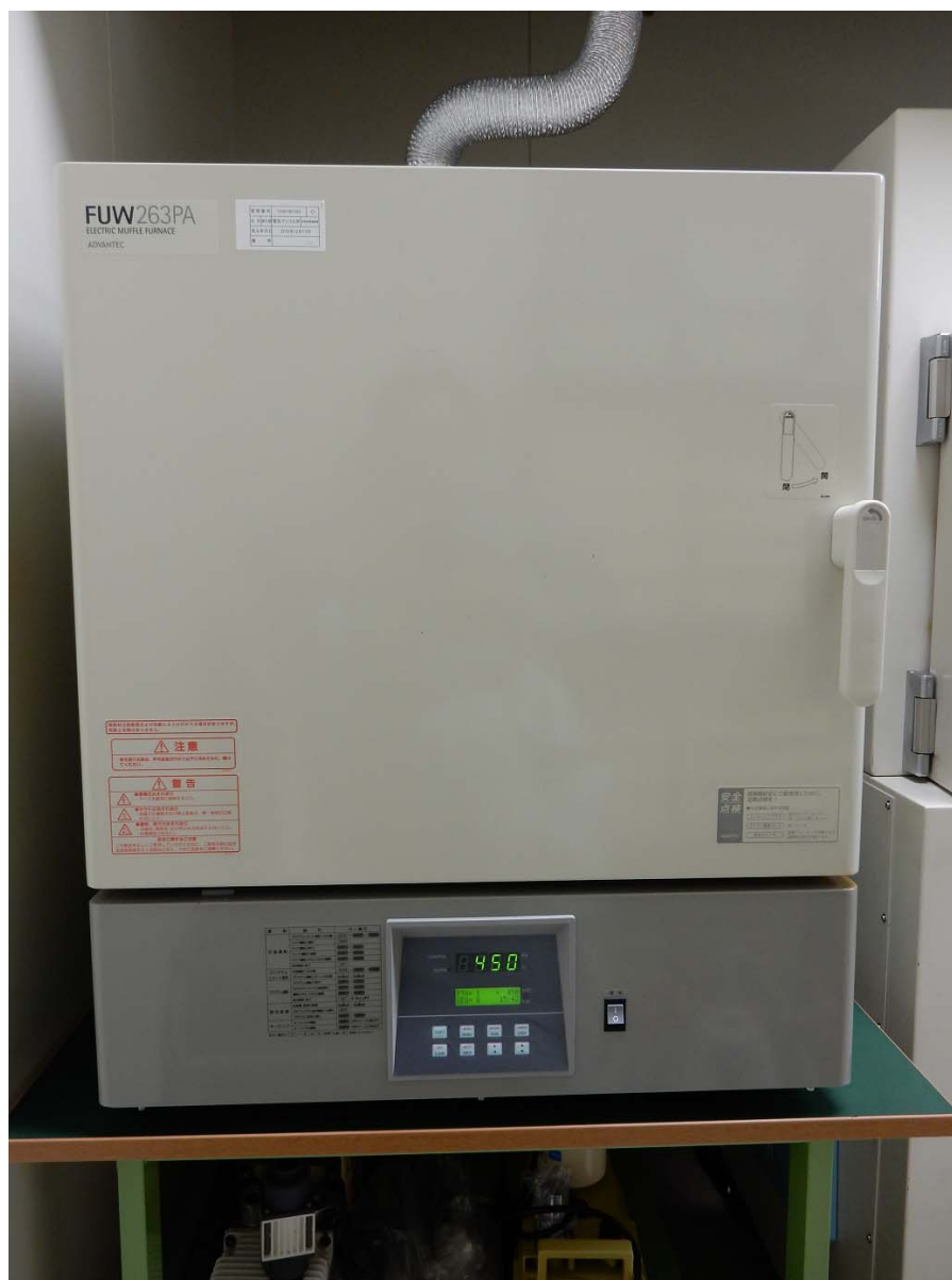
海産生物（わかめ）を灰化するために2015年に新規整備した電気炉。
