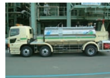
散水車（下水処理水を活用）
