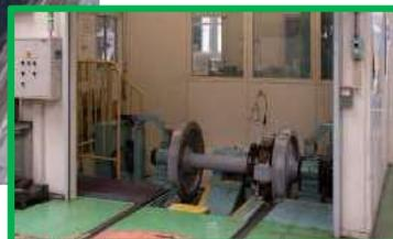
車輪回転試験：車輪を疑似的に走らせ、発熱、異音、振動の有無を検査します。
