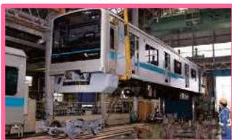
台車組立装置：車体を支える台車に支持装置や車輪を取り付ける際に使用します。
