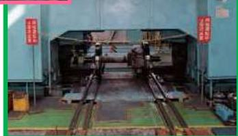
車輪旋盤：車輪の傷を削り、乗り心地を向上させます。
