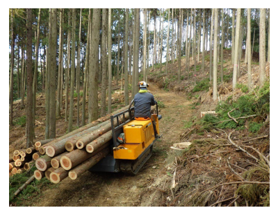
フォワーダによる運材作業の様子
