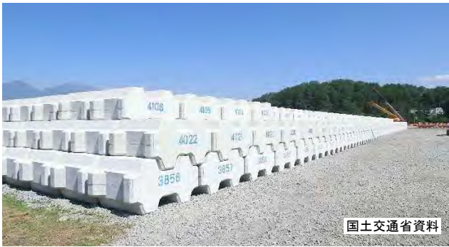
図 4-6 コンクリートブロックの備蓄例（浅間山）
