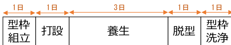
図 4-3 コンクリートブロック製作サイクル
