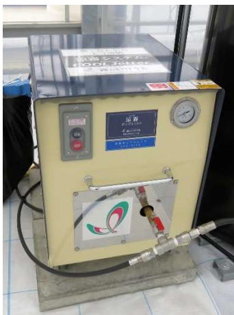
図1-3-1 細霧発生装置 粒径は10～30 μm。
