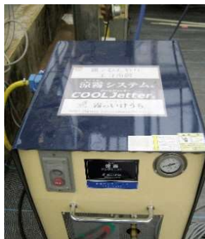
図Ⅲ-2-3 細霧発生装置 粒径は 10 \sim 30 \mu\text{m}
