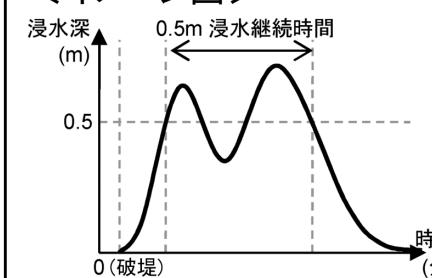
※一旦水が引いて0.5mを下回った後、再び増水して0.5mを上回った場合は、最初に0.5mを上回ってから、最終的に0.5mを下回るまでの通算時間(0.5mを下回っている時間を含む)とする。
