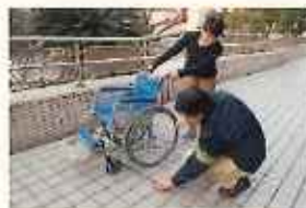
スロープの段差等の調査
