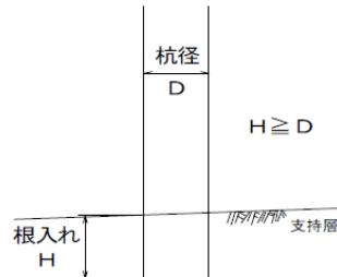
イ 良質な支持層が深い場合には、上部構造の形式や機能、荷重規模、施工性、経済性等を総合的に検討した上で、摩擦杭を採用してもよい。この場合は、周面摩擦力により所定の支持力が得られる根入れ深さを確保した上で、中間層に根入れをする。
