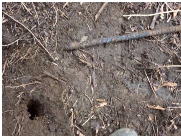
抜き出した鉄筋杭とその跡
