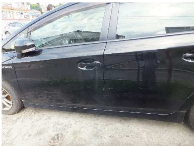
助手席側面①複数の線状の傷、塗料の付着
