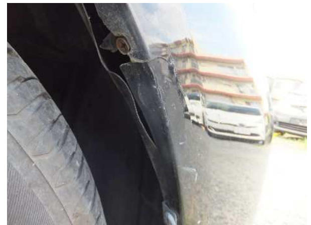
タイヤ付近のボディの損傷
