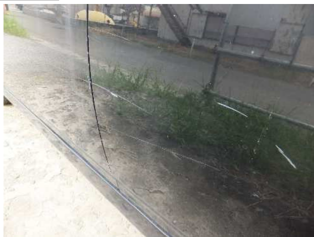
助手席側面②複数の線状の傷、塗料の付着
