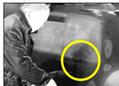
図1 給油時の「ガソリンベーパー」の映像(赤外線カメラで撮影) 白丸内の黒い煙が「ガソリンベーパー」
