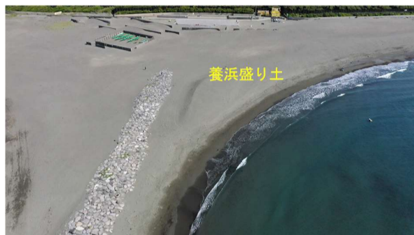
【ヘッドランド東側にそのまま残された養浜盛り土】
