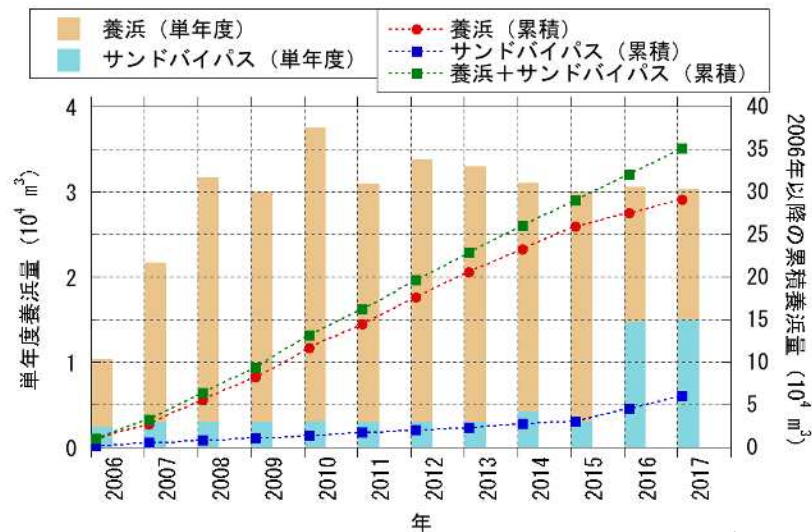
(b) 中海岸 養浜V = 15,270 m 3 (2016年2~3月) + サンドバイパス V=15,000 m 3 (2016年12月, 2017年1月)
