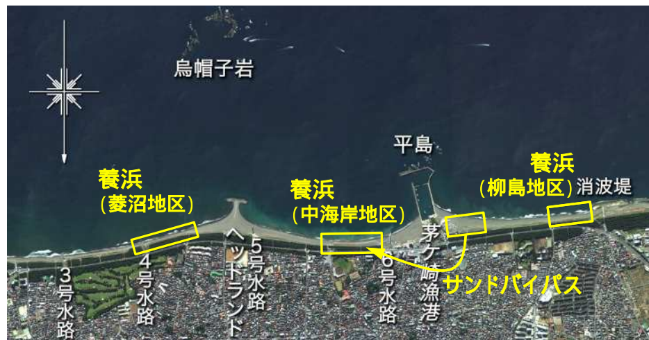
(b) 中海岸 養浜V = 15,270 m 3 (2016年2~3月) + サンドバイパス V=15,000 m 3 (2016年12月, 2017年1月)
