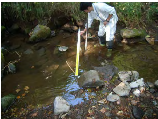
対照流域モニタリング（フチデリ沢試験流域）の水文観測地点の流量実測（南足柄市荻野）
